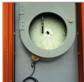
Schreibgerät für Zugkraftmessgerät
