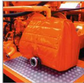
Heizmantel für Kolbenpumpe
